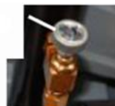
Vis de réglage de l'avance
